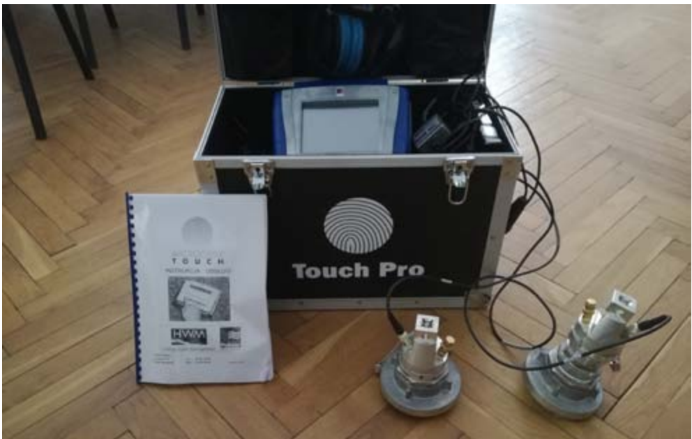
Kolerator do wykrywania awarii i przecieków na sieciach wodociągowych.
